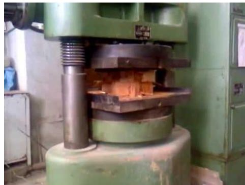
Рис. 5 Фотофрагмент проведения испытания образца на сжатие
