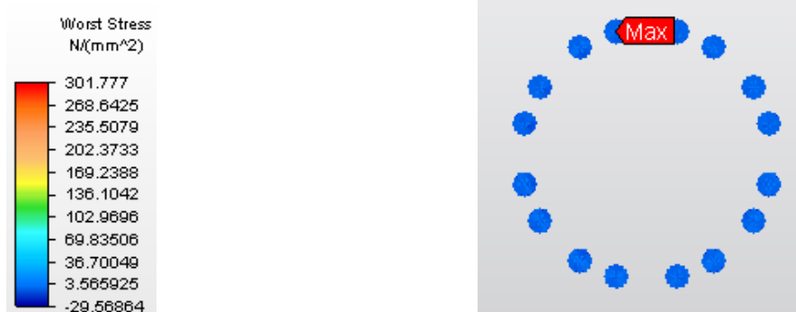
Рис. 3 Максимальні зусилля в болтах фланцевої групи
