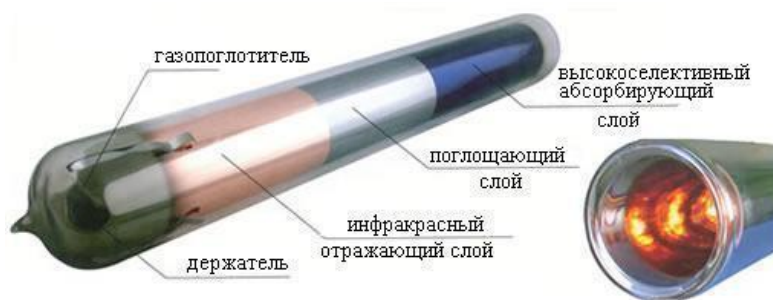
Рис. 2. Устройство вакуумных трубчатых солнечных коллекторов
