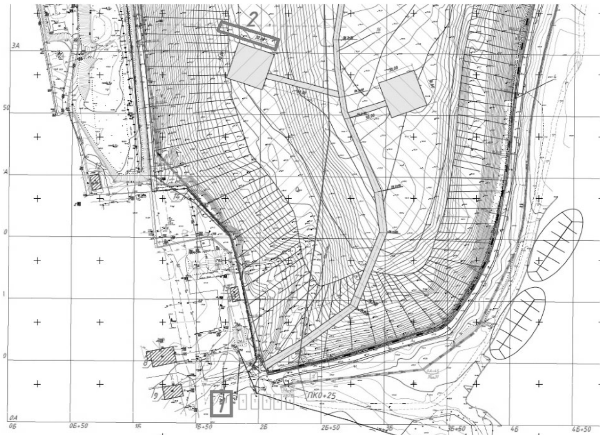
Рис.1. Схема розташування експериментальної ділянки: 1 – майданчик для розвантаження; 2 – експериментальна ділянка
