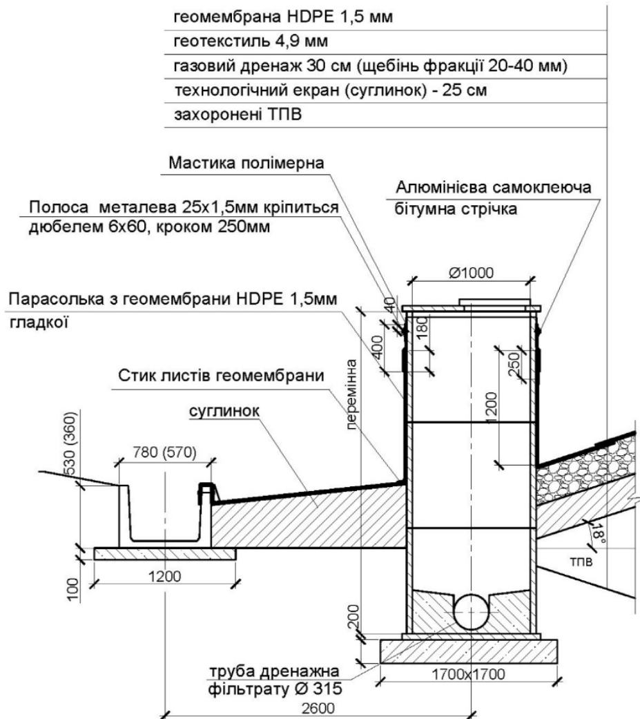
Рис. 4. Схема укладання геомембрани біля колодязя
