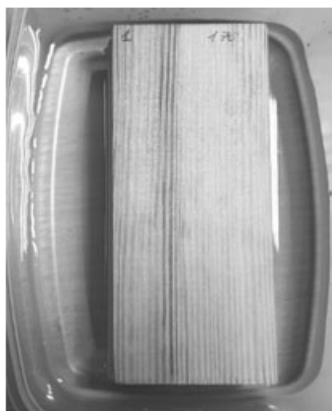
Рис. 3 Процес вимивання антипіренів водою із зразка деревини
