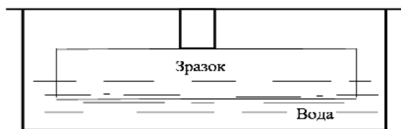
Рис. 2. Пристрій для випробувань на вимивання вогнезахисних засобів
