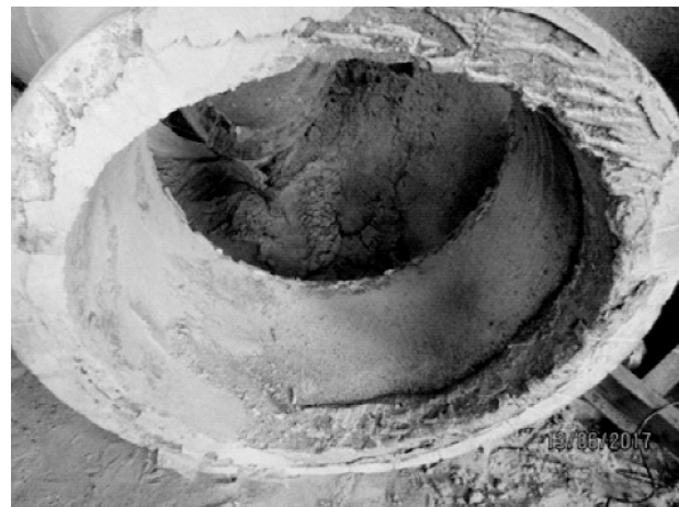
Рис. 7. Загальний вид стику після розрізу, загерметизованого за четвертою технологією
