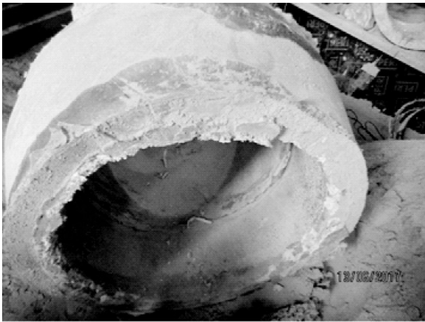
Рис. 5. Загальний вид стику після розрізу, загерметизованого за першою технологією
