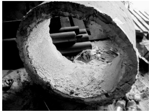
Рис. 10. Загальний вид стику після розрізу, загерметизованого за п'ятью технологією
