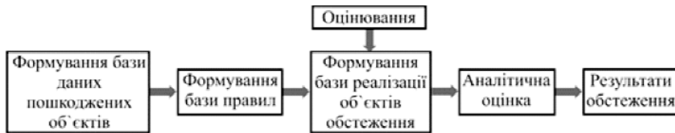
Рис.4 Схема функціонування інформаційної системи управління для діагностики технічного стану будівель
