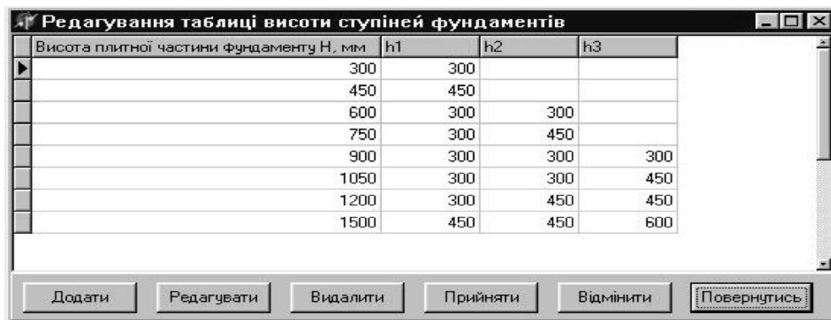
Рис. 15 БД ступеней для плит стовпчастих фундаментів
