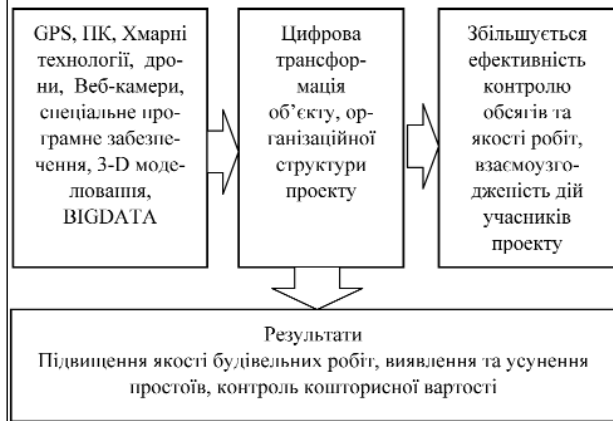
Рис.1 Цифрова трансформація будівництва на рівні окремого проекту
