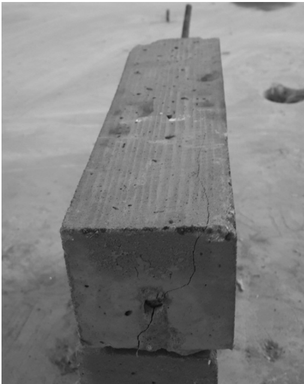
Фото 4. Дослідний зразок з ребристою арматурою після випробування
