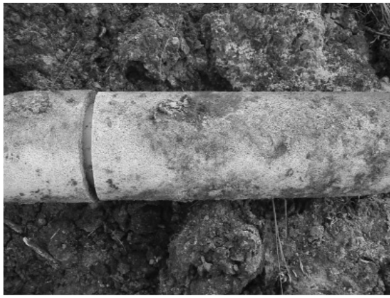
Рис. 5. Образцы ПВМ-трубофильтров после 10-летней эксплуатации
