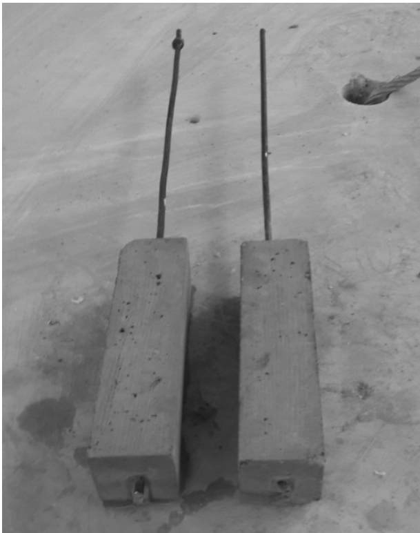
Фото 2. Дослідні зразки з гладкою арматурою до випробування (з ліва) та після випробування (з права)
