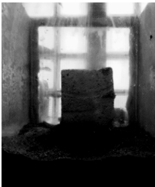
Рис. 4. а) модель горизонтального экрана в мелкозернистом песке
