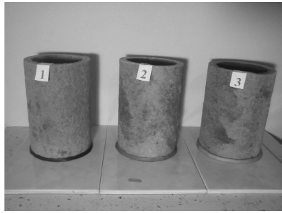
Рис. 5. Образцы ПВМ-трубофильтров после 10-летней эксплуатации
