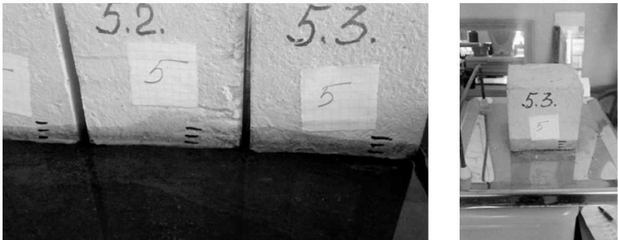
Рис. 2. Испытание образцов на капиллярное всасывание
