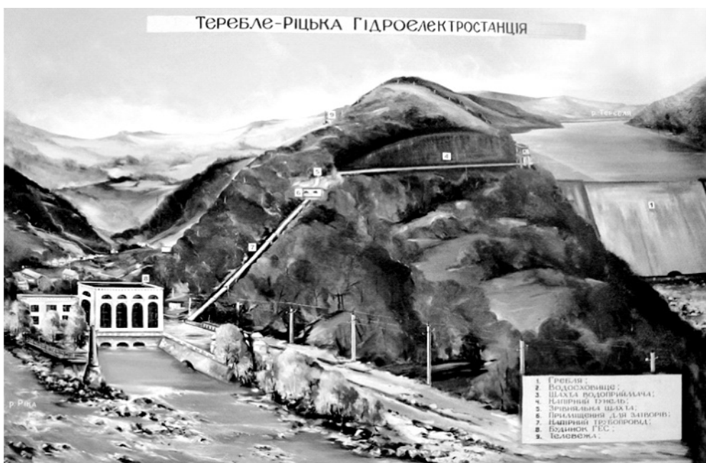
Рис.1 – Схема влаштування Теремле-Ріцької ГЕС
