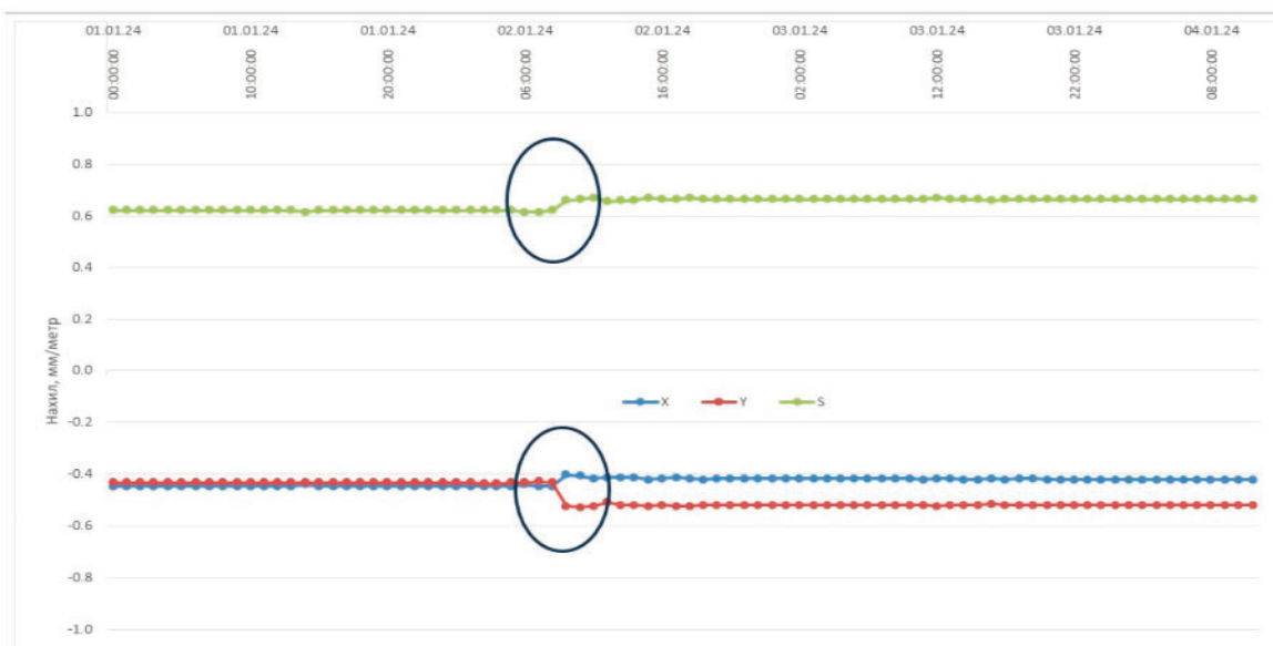
Рис. 7 Дані з датчика, встановленого на позначці +62,500 м. (блок №2) за період з 01.01.2024 по 04.01.2024
