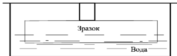
Рис. 2. Пристрій для випробувань на вимивання вогнезахисних засобів
