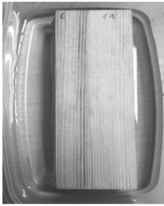
Рис. 3 Процес вимивання антипіренів водою із зразка деревини
