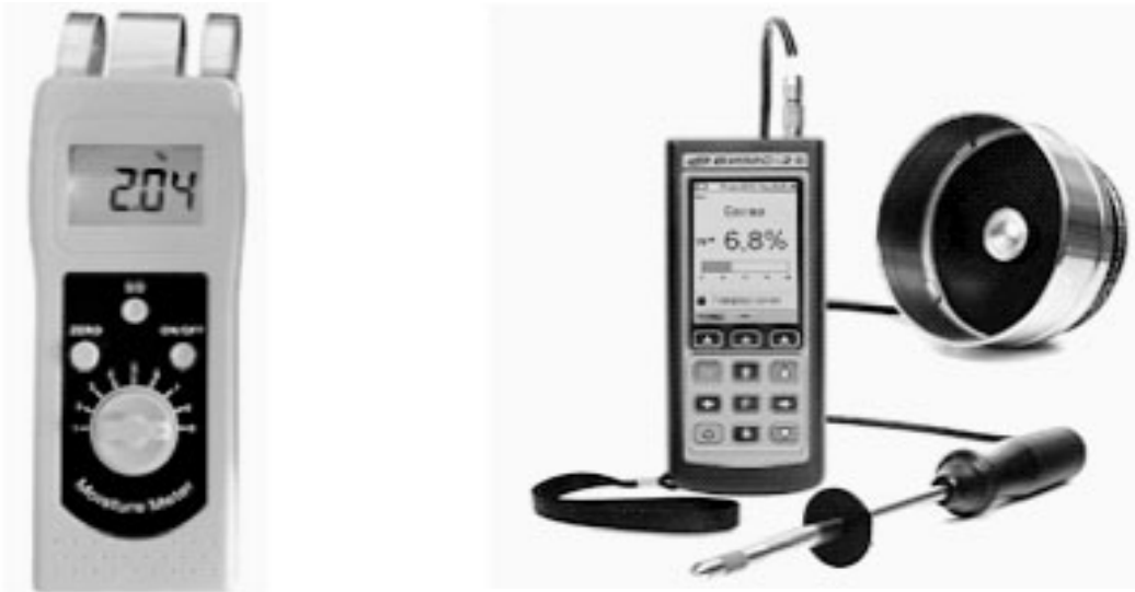
Рис. 8. Загальний вигляд вологомірів: а – DM200C; б – ВИСМ-2 [7]
