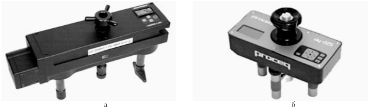
Рис. 1. Прилади для визначення міцності бетону методом відриву зі сколюванням
