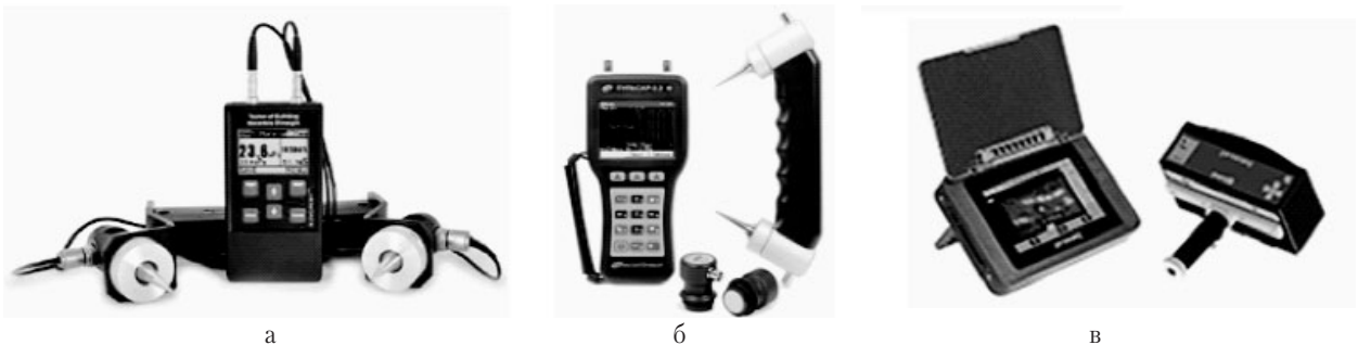
Рис. 4. Ультразвукові прилади для визначення міцності бетону: а – NOVOTEST ИПСМ-У 10 ; б – ПУЛЬСАР 2.2 7 ; в – Pundit 250 Array [8]
