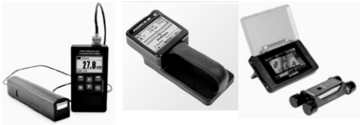
Рис. 6. Прилади для визначення параметрів армування конструкцій: а – NOVOTEST арматуроскоп 13 ; б – ПОИСК-М 7; в – Profometer 630 AI [8]
