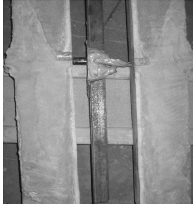
Рис. 6. Вигляд стику №7 нижня частина якого заповнена ущільнювачем поліуретановий Ø 20 з притисканням металевго кутика на підпорці
