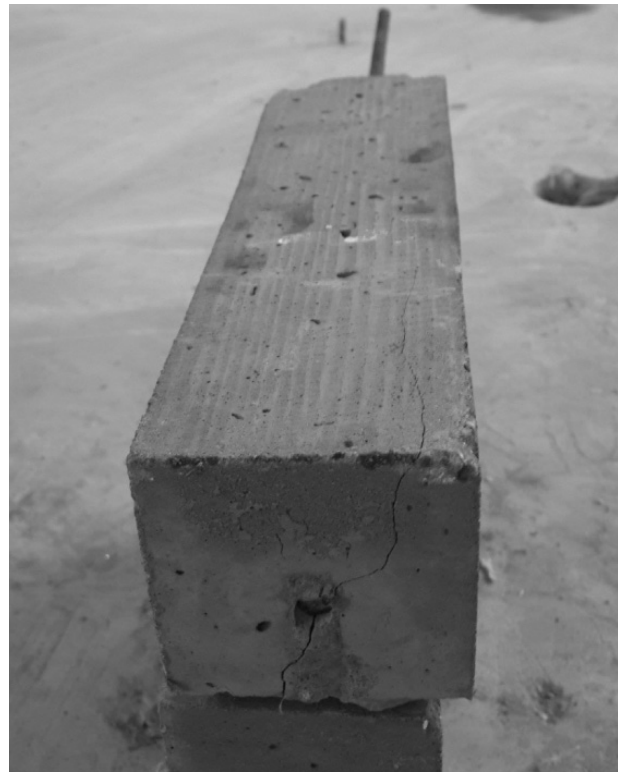
Фото 3. Дослідний зразок з гладкою арматурою після випробування
