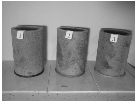
Рис. 5. Образцы ПВМ-трубофильтров после 10-летней эксплуатации
