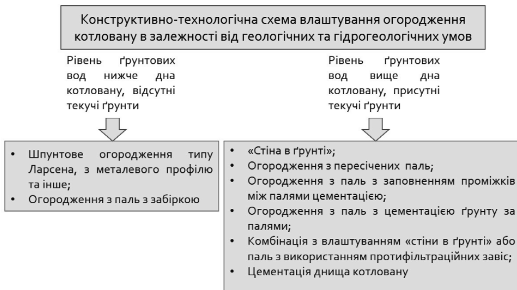
Рис. 1. Алгоритм вибору конструктивно-технологічного типу огородження котловану в залежності від рівня ґрунтових вод
